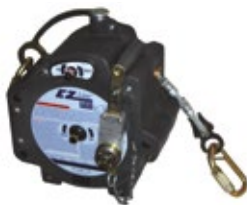
Ligne de vie temporaire EZ LINE Longueur 18 m Câble en acier galvanisé de 8 mm 2 utilisateurs maximum Conforme EN 795C.
