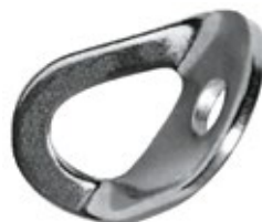
Point d'ancrage type PRAM 210 Acier inox. Conforme EN 795/A. Fixation par boulon inox. M12. Résistance 12 KN.
