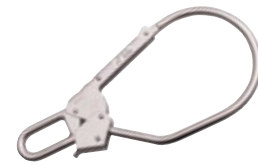
Mousqueton à vis type PRAJ 592 Ouverture 85 mm. Résistance 18 KN. Conforme EN 362.
