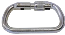
Mousqueton à vis type PRAJ501 Ouverture 17 mm. Résistance 25 KN. Conforme EN 362.
