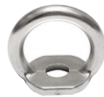
Point d'ancrage type PRAM 211 Acier inox. Conforme EN 795/A. Fixation par boulon inox. M12. Résistance 12 KN.
