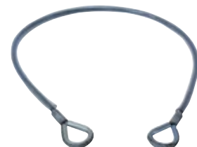
Elingue AM 401G Longueur 1 m. Résistance 22 KN. Conforme EN 795.
