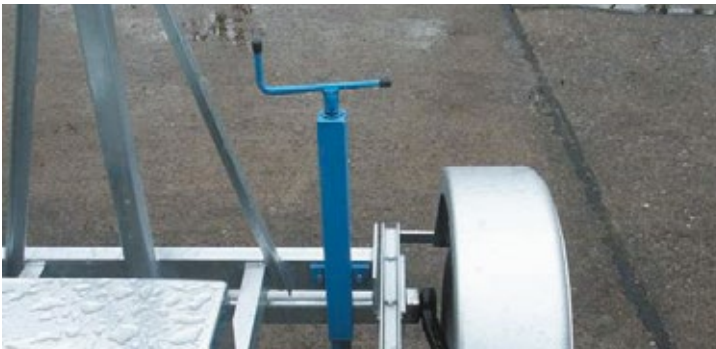
Pied de stabilisation avec manivelle.
