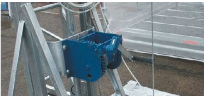
Treuil de montage avec grande démultiplication.
