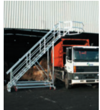
Escabeau pour prélèvements dans les bennes de camion en sécurité.
