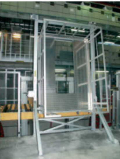
Passerelle en U de type pont-levis pour le contrôle des tôles chez C.S.T.B. (Groupe Arcelor).
