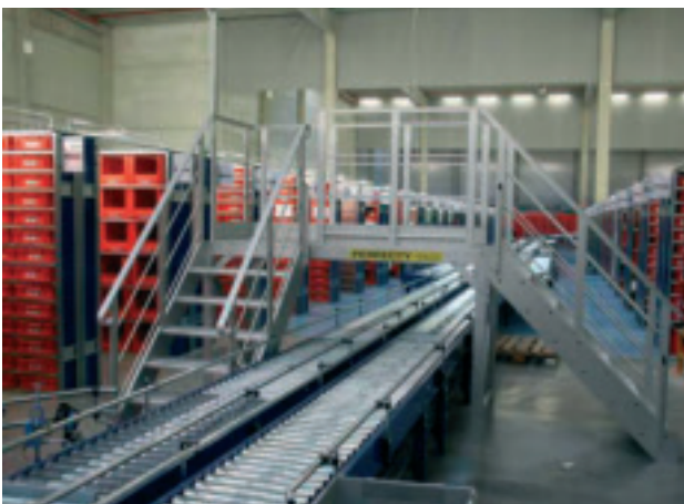
Escalier permettant de passer au-dessus d'une chaîne de production
