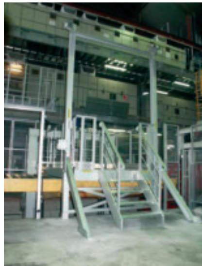
Passerelle en U de type pont-levis pour le contrôle des tôles chez C.S.T.B. (Groupe Arcelor).
