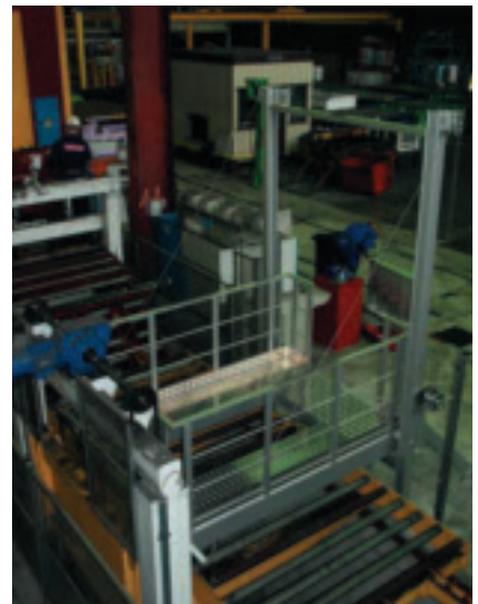
Passerelle en U de type pont-levis pour le contrôle des tôles chez C.S.T.B. (Groupe Arcelor).
